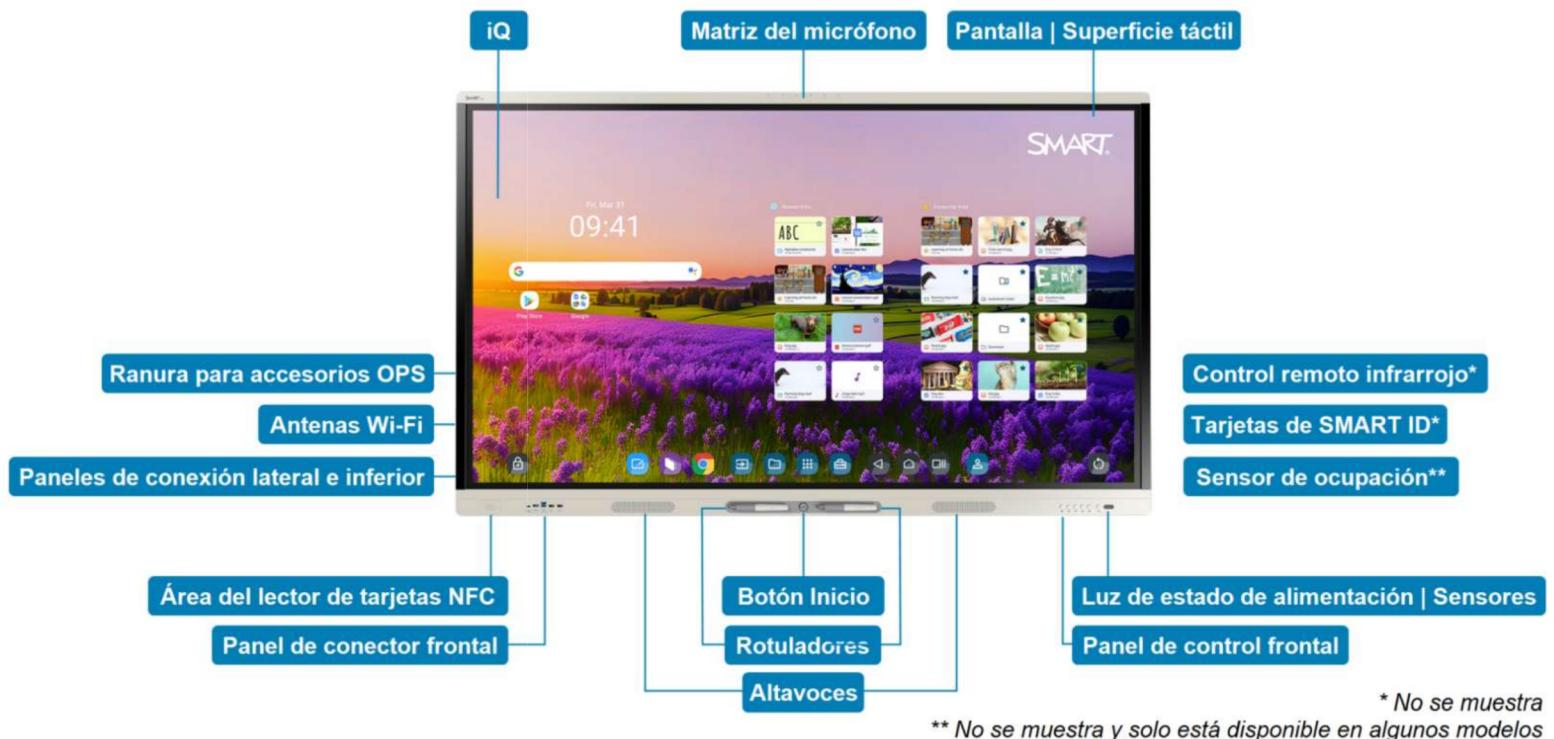
La pantalla viene con el sistema operativo iQ que es una versión adaptada de Android, el mismo de los teléfonos móviles. Por otro lado, cuenta con un mini PC acoplado (OPS) con el sistema operativo EducandOS y Microsoft Windows.
